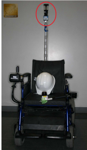
図3 全方位カメラ取り付け位置
