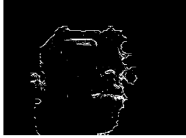
図5 Y方向 Sobel フィルタを適用後二値化
