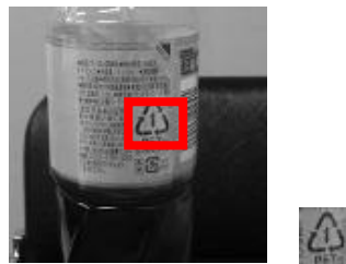
図 1912 テンプレート画像(右)の例と検出例(左の枠内)
